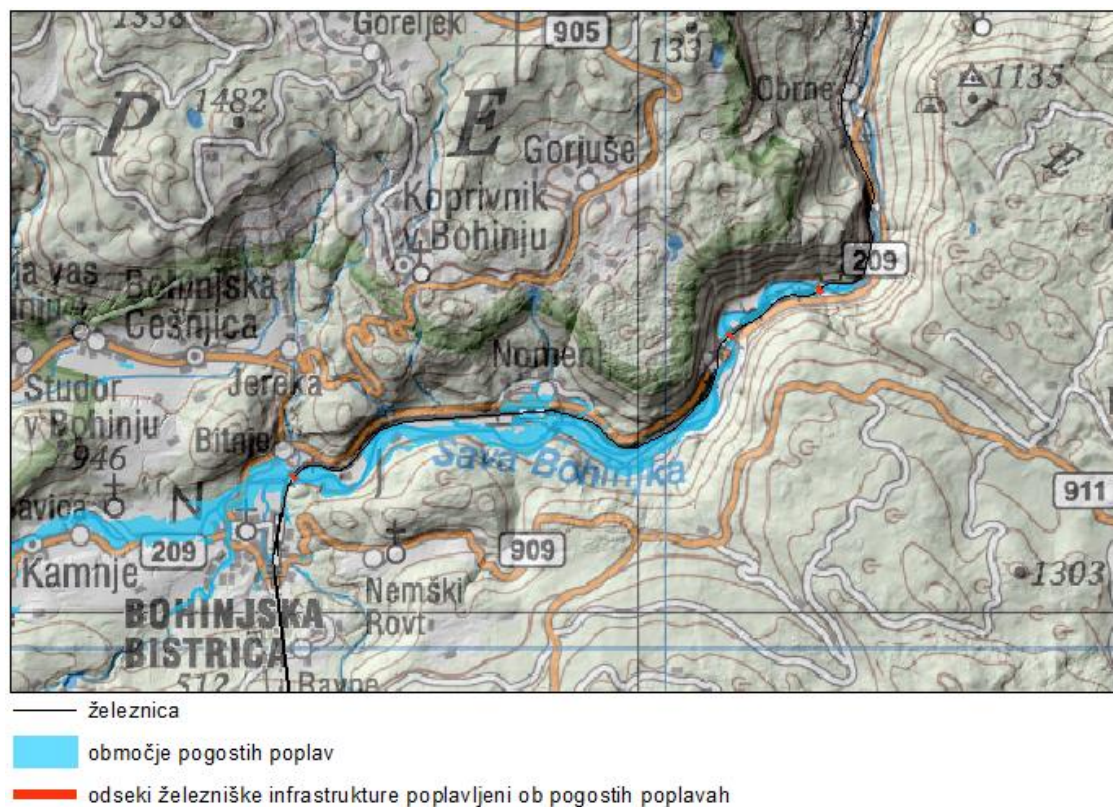
Karta 22: Odseki železniške infrastrukture v smeri od Bohinjske Bistrice do Bohinjske Bele, poplavljeni ob pogostih poplavah
